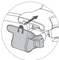
按照箭头指示方向装上云台保护罩
