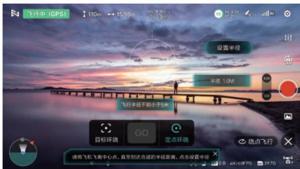
绕点飞行过程中，可以在Fimi Navi 3.0 APP上设置绕点飞行的转向和速度，点击“X”退出绕点飞行。
