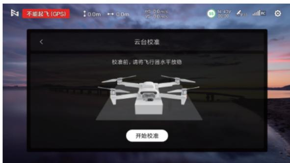
⚠️ · 校准前请先连接飞机和云台，飞行中无法进行云台校准。
