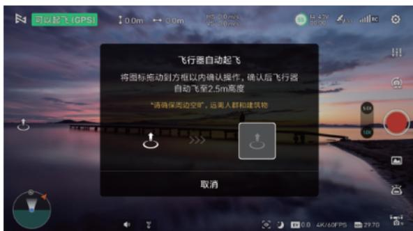
GPS模式下飞行器自动起飞后悬停在距离地面2.5米的位置等待摇杆指令；VPU模式下，飞行器自动起飞后悬停在距离地面1.2米的位置等待摇杆指令。
