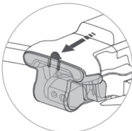
按照箭头指示方向拆下云台保护罩
