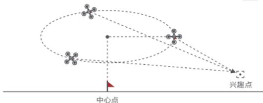
如果在飞行中操作摇杆，已经设定的飞行高度或半径将会改变。
