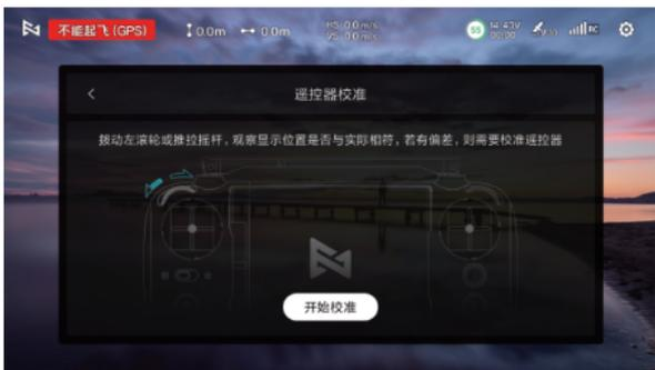
⚠️ 遥控器校准时，请关闭飞行器电源；飞行中，无法校准遥控器。
