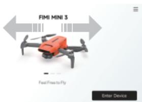
Scorrere a sinistra e a destra per cambiare modello; se il telecomando è già collegato al velivolo, identificherà e cambierà automaticamente il modello dopo l'apertura dell'APP.
