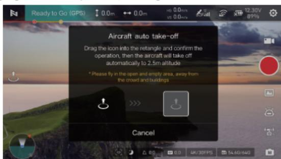
In modalità GPS, il velivolo decollerà automaticamente e si libererà a 2,5 metri dal suolo in attesa del comando del joystick; in modalità VPU, il velivolo decollerà automaticamente e si libererà a 1,2 metri dal suolo in attesa del comando del joystick.
