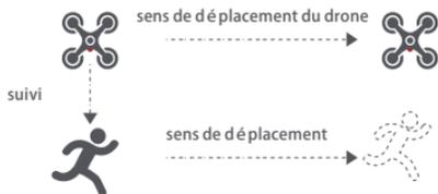
Mode verrouillage, le drone reste en statinaire sans bouger mais la caméra suivra la cible à 360°. L'utilisateur peut également régler la vitesse de vol et le drone volera à une certaine distance.
